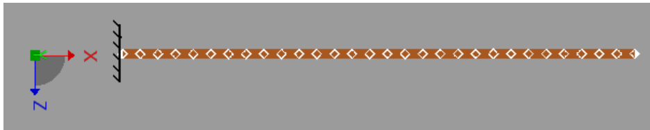
Figure 3 : Représentation géométrique de la poutre (L=1m) pour 30 nœuds
