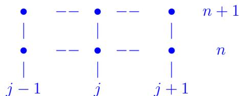
Le schéma est implicite. Le principe de causalité est a priori respecté et ne permet pas de définir une condition nécessaire de stabilité puisque la caractéristique est incluse dans le stencil.
