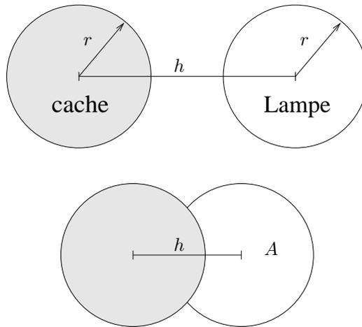
FIG. 1 – Lampe simple avec un cache pour ajuster la quantité de lumière
