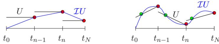
FIGURE 1.1 – Approximation polynomiale  $U$  en noir d'ordre  $d = 0$  (gauche) et  $d = 1$  (droite). L'opérateur d'interpolation  $\mathcal{I}$  dont la restriction à chaque intervalle  $I_n$  est  $\mathcal{I}_n$  est représenté en bleu. Les points d'interpolation sont représentés en rouge (ceux de l'ordre 0) et en vert (ceux de l'ordre 1).
