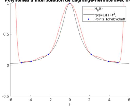
Figure: Polynôme d'interpolation de Lagrange-Hermite avec  $n = 6$  (7 points) pour la fonction  $f : x \rightarrow 1/(1 + 25x^2)$ . A gauche avec des points uniformément répartis et à droite avec des points de Tchebychev
