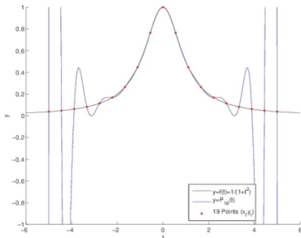
Polynômes d'interpolation de Lagrange avec  $n = 18$  (19 points) uniformément répartis. A gauche pour la fonction  $f : t \rightarrow \sin(t)$  avec  $x_0 = 0$ ,  $x_{18} = 2\pi$  et à droite pour la fonction  $f : t \rightarrow 1/(1+t^2)$  avec  $x_0 = -5$ ,  $x_{18} = 5$ .
