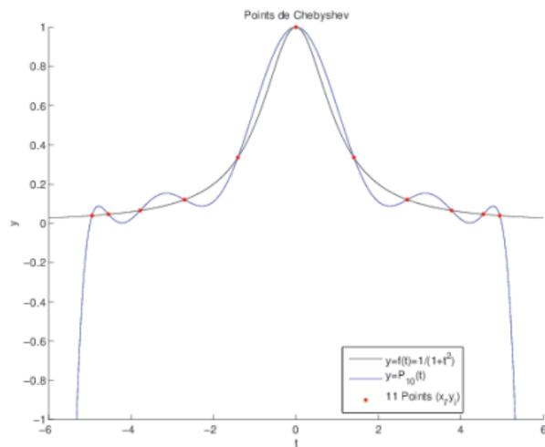
Figure: Erreurs d'interpolation avec  $n = 10$
