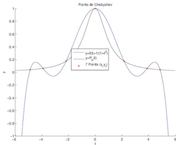
Figure: Erreurs d'interpolation avec  $n = 6$
