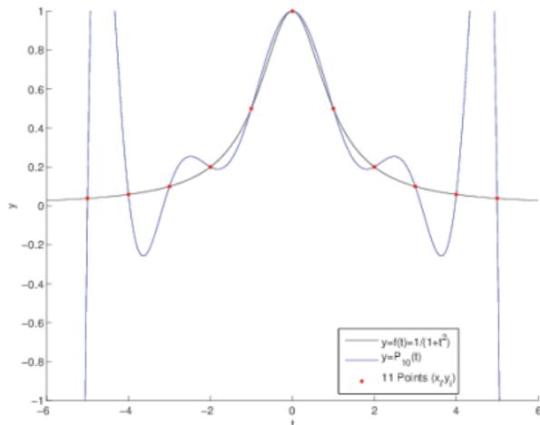
Polynômes d'interpolation de Lagrange avec  $n = 10$  (11 points) uniformément répartis. A gauche pour la fonction  $f : t \rightarrow \sin(t)$  avec  $x_0 = 0$ ,  $x_{10} = 2\pi$  et à droite pour la fonction  $f : t \rightarrow 1/(1+t^2)$  avec  $x_0 = -5$ ,  $x_{10} = 5$ .
