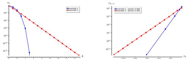
(a) Erreurs en fonctions des itérations (b) Représentation en échelle logarithmique de  $e_{k+1}$  en fonction de  $e_k$ . Les pentes sont calculées numériquement
