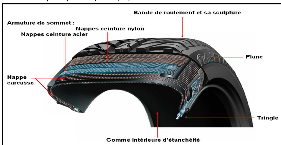
Figure 5: Coupe d'un pneumatique de tourisme
