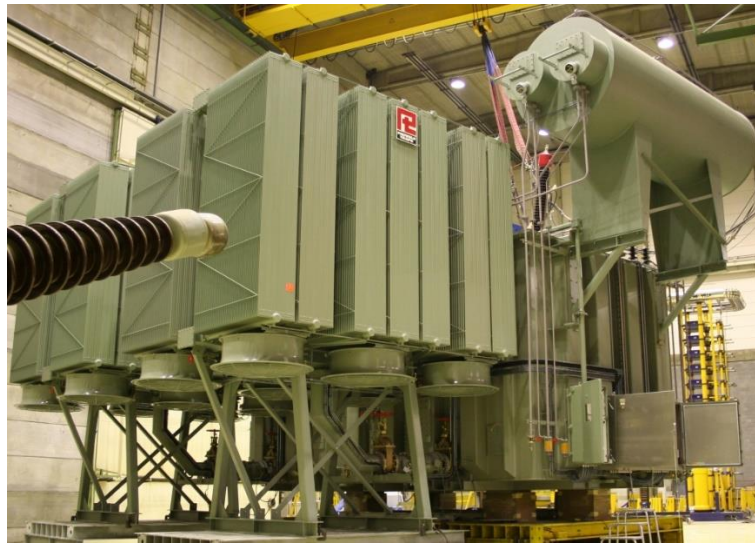
FIGURE 9 : LE BANC DE RADIATEUR AVEC DES VENTILATEURS DESSOUS SOURCE : RTE
