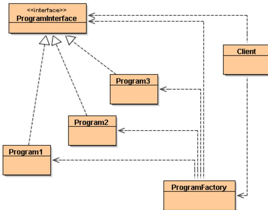
On voit bien sur le diagramme de classe que le *Client* n'a plus connaissance de l'existence de *Program1*, *Program2* ou *Program3*. Il se contente de voir l'interface *ProgramInterface* et le *ProgramFactory*.
