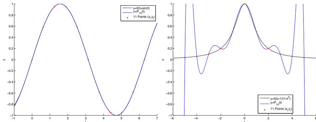
Figure 4.4: Polynômes d'interpolation de Lagrange avec  $n = 10$  (11 points) uniformément répartis. À gauche pour la fonction  $f : x \rightarrow \sin(x)$  avec  $x_0 = 0$ ,  $x_{10} = 2\pi$  et à droite pour la fonction  $f : x \rightarrow 1/(1 + 25x^2)$  avec  $x_0 = -5$ ,  $x_{10} = 5$ .
