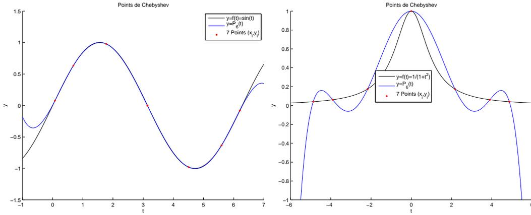
Figure 4.6: Erreurs d'interpolation avec  $n = 6$
