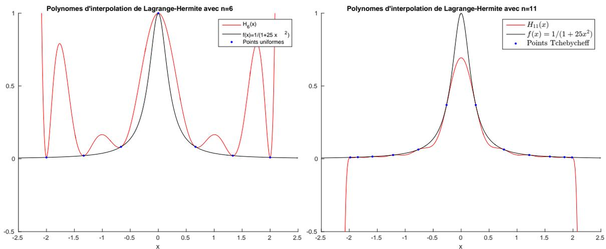
Figure 4.9: Polynôme d'interpolation de Lagrange-Hermite avec  $n = 6$  (7 points) pour la fonction  $f : x \rightarrow 1/(1 + 25x^2)$ . A gauche avec des points uniformément répartis et à droite avec des points de Tchebychev
