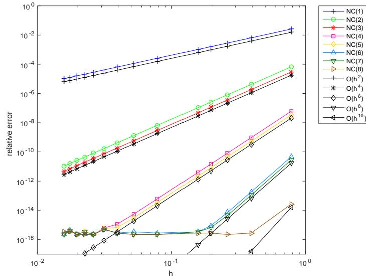
Figure 5.9: Erreur des méthodes de Newton-Cotes composées pour le calcul de  $\int_0^{\pi/2} \cos(x)dx$ , NC(n) correspondant à  $\mathcal{Q}_{k,n}^{\text{comp}}$  et  $h = \frac{\pi}{2k}$ .
