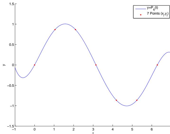
Figure 4.2: Polynôme d'interpolation de Lagrange avec 7 points donnés)
