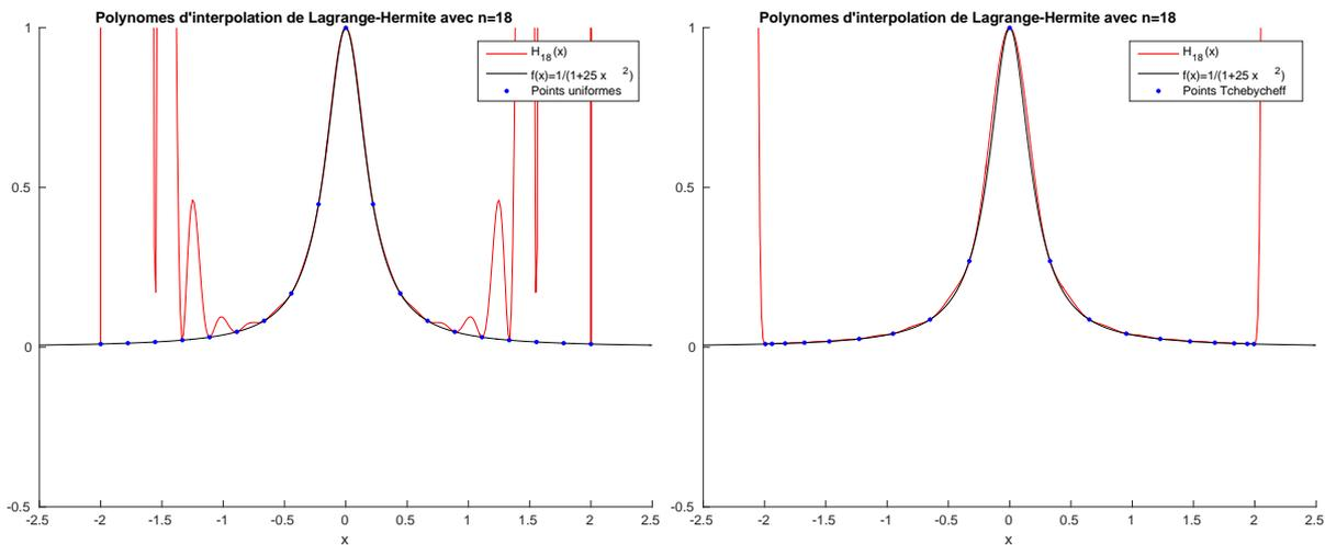
Figure 4.11: Polynôme d'interpolation de lagrange-Hermite avec  $n = 18$  (19 points) pour la fonction  $f : x \rightarrow 1/(1 + 25x^2)$ . A gauche avec des points uniformément répartis et à droite avec des points de Tchebychev
