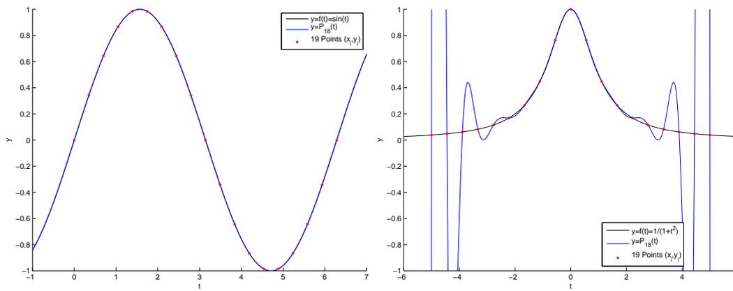
Figure 4.5: Polynômes d'interpolation de Lagrange avec  $n = 18$  (19 points) uniformément répartis. A gauche pour la fonction  $f : x \rightarrow \sin(x)$  avec  $x_0 = 0, x_{18} = 2\pi$  et à droite pour la fonction  $f : x \rightarrow 1/(1+x^2)$  avec  $x_0 = -5, x_{18} = 5$ .
