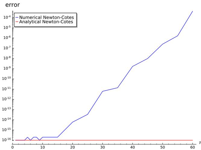
Figure 5.5: Instabilité des méthodes de Newton-Cotes élémentaires
