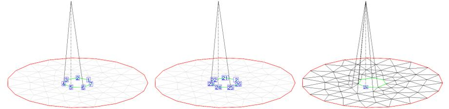
Figure: Fonction de base  $\Gamma_1^h \cdot \varphi_5$ , numérotation locale (gauche) et globale (centre). Fonction de base  $\Omega^h \cdot \varphi_{24}$  (droite).
