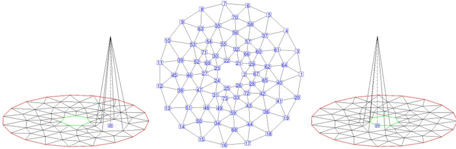
Figure: Numérotation des noeuds de  $\Omega^h$  (centre), fonctions de base  $\Omega^h \cdot \varphi_{43}$  (gauche) et  $\Omega^h \cdot \varphi_{24}$  (droite) appartenant à  $V(\Omega^h)$ .
