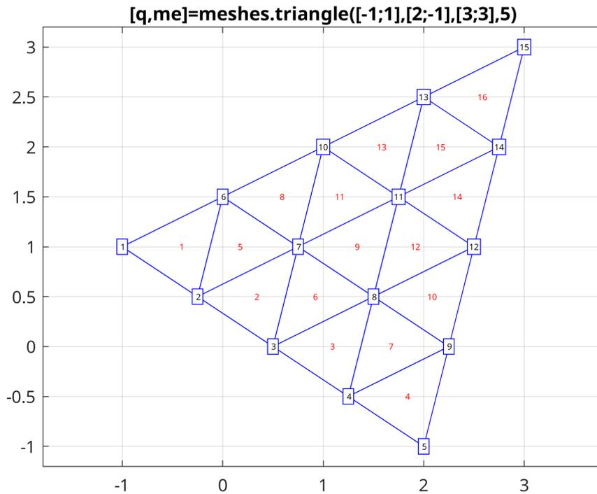
FIGURE 5 – Maillage du triangle de sommets  $(-1, 1)$   $(2, -1)$  et  $(3, 3)$  avec des triangles.
