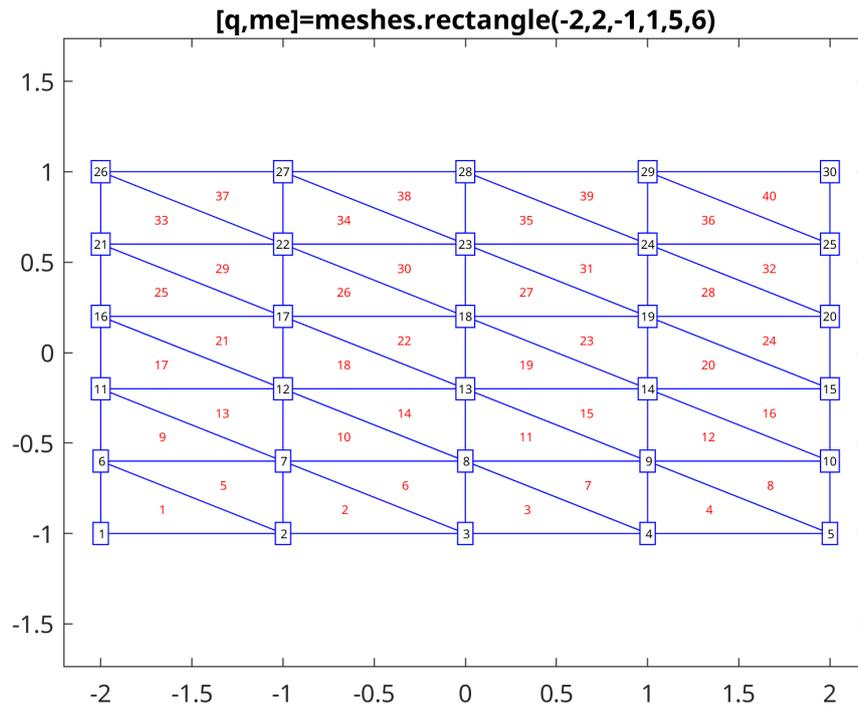
FIGURE 3 – Maillage du rectangle  $[a, b] \times [c, d]$  avec des triangles.
